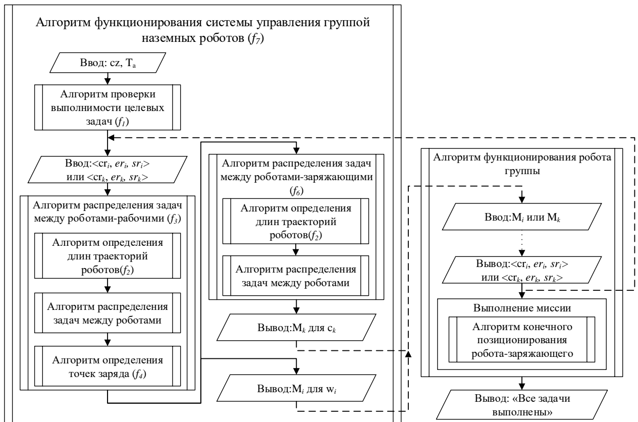
Рисунок 6 – Комплекс алгоритмов управления группой наземных роботов
