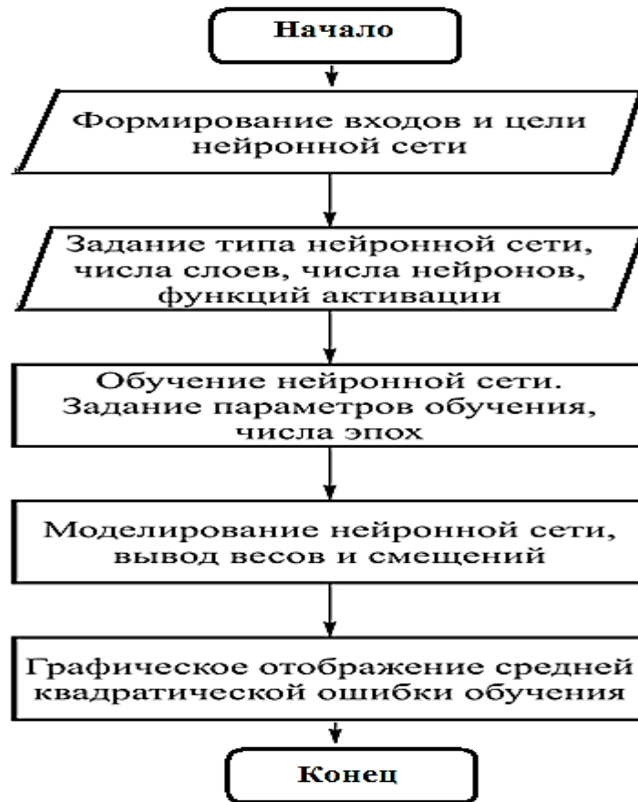
Рисунок 2.3.7– Алгоритм моделирования обучения экспертной нейронной сети
