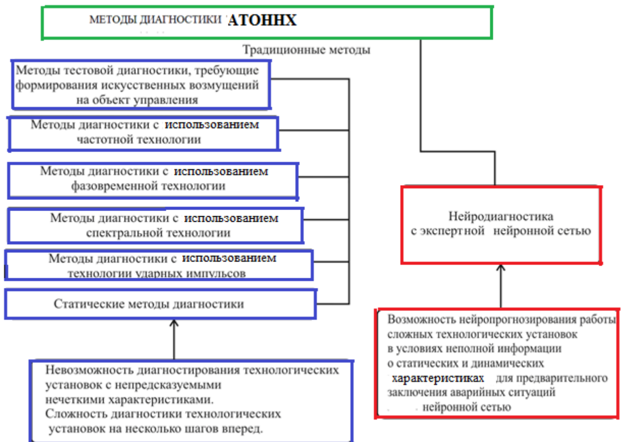
Рисунок 2.3.1 – Структурная схема методов диагностики АТОННХ
