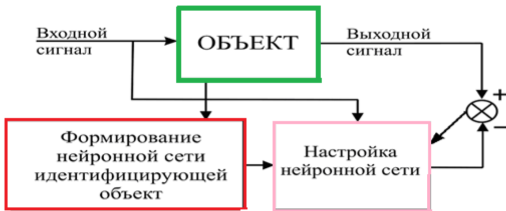
Рисунок 1.1.4 – Структурная схема нейроидентификации динамического объекта
