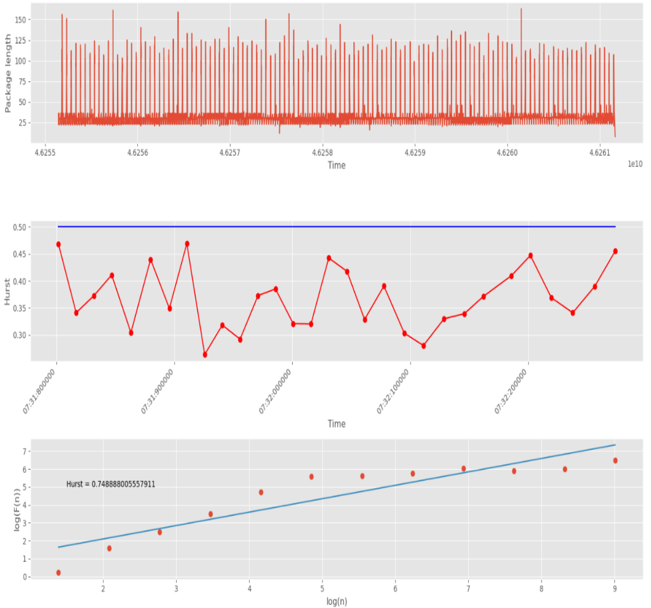
Рисунок 3.5 – Вычисление H методом фрактального анализа аномального UDP трафика. Разбиение 10000 точек на 29 групп
