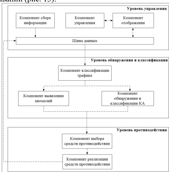
Рисунок 15 – Архитектура системы раннего обнаружения и классификации КА в сетевом трафике СПД
