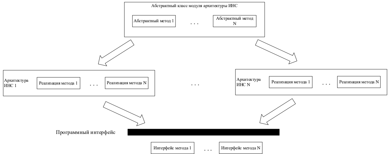
Рисунок 3.4 – Обобщённая схема реализации шаблона проектирования «Фасад» в разработанном ПО
