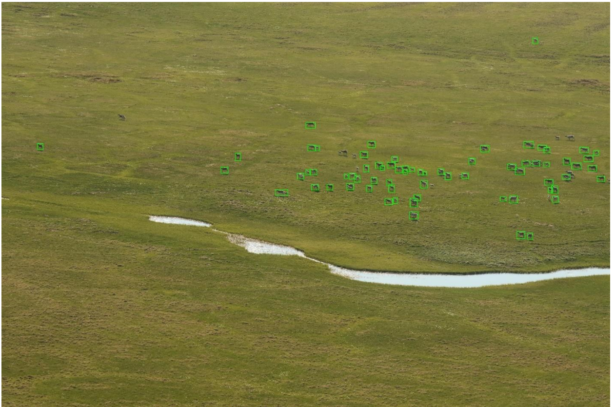
Рисунок 4.14 – Результат распознавания модели MRCNN дообученной на аэрофотоснимках
