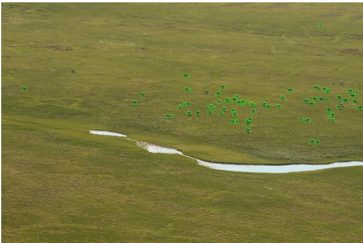
Рисунок 4.14 – Результат распознавания модели MRCNN дообученной на аэрофотоснимках
