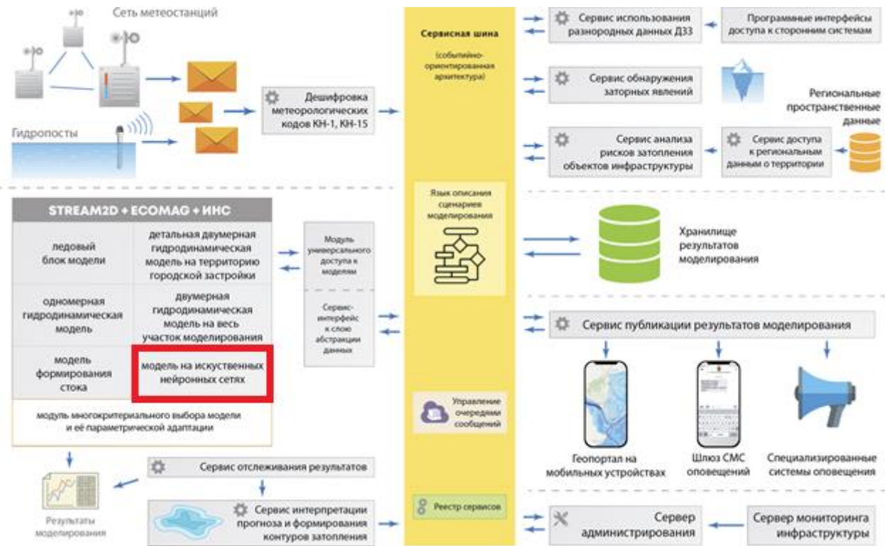
Рисунок 4.9 – Детальная схема ИС «ПРОСТОР» с указанием местоположения разработанной модели ИНС в общей структуре
