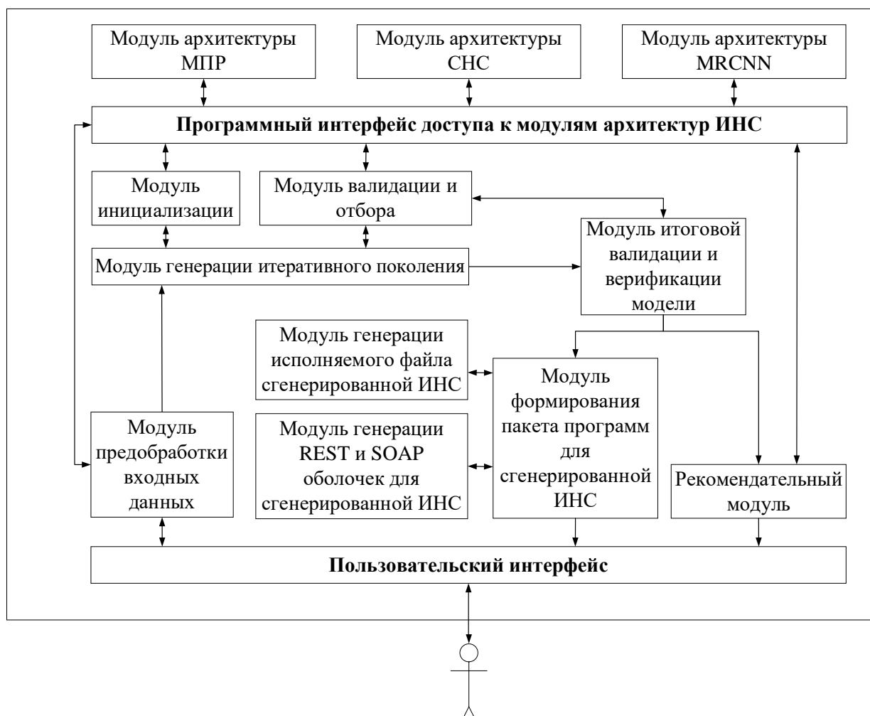
Рисунок 2 – Детальная схема ПО комплексной автоматизации процессов генерации, обучения и использования моделей ИНС ПР различных архитектур
