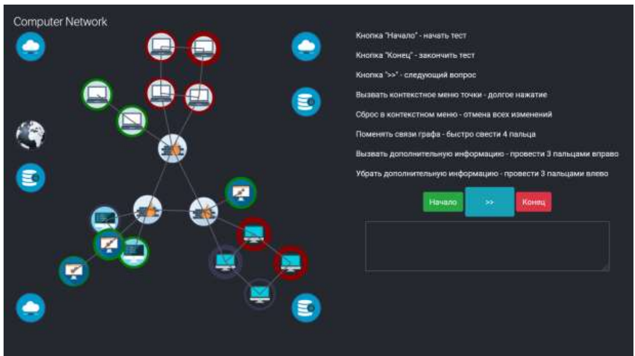
Рисунок 27 – Пример взаимодействия оператора с визуальной моделью компьютерной сети – смена топологии сети с физической на логическую
