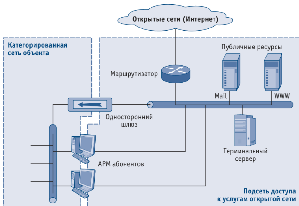
Рисунок 1.6 – Доступ через терминальный сервер из сети общего пользования к категорированной сети объекта [7]
