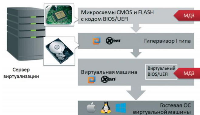
Рисунок 1.23 – Схема доверенной загрузки 72 уровня BIOS виртуальной инфраструктуры с гипервизором первого типа [78]
