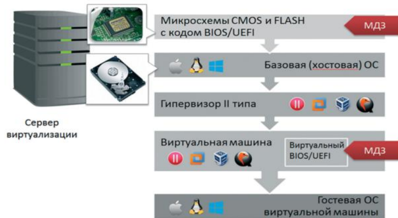
Рисунок 1.24 – Схема доверенной загрузки 72 уровня BIOS виртуальной инфраструктуры с гипервизором второго типа [78]
