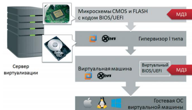
Рисунок 1.23 – Схема доверенной загрузки уровня BIOS виртуальной инфраструктуры с гипервизором первого типа [78]
