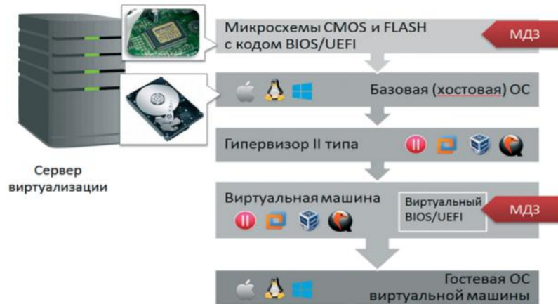
Рисунок 1.24 – Схема доверенной загрузки уровня BIOS виртуальной инфраструктуры с гипервизором второго типа [78]
