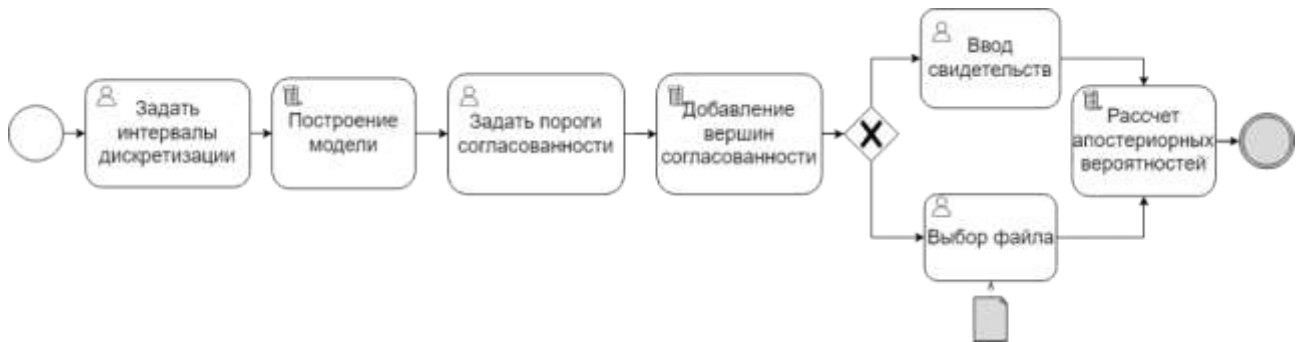
Рисунок 3.3 — Схема алгоритма оценивания согласованности информации о последних эпизодах и рекордных интервалах пуассоновского процесса в модели оценивания его интенсивности
