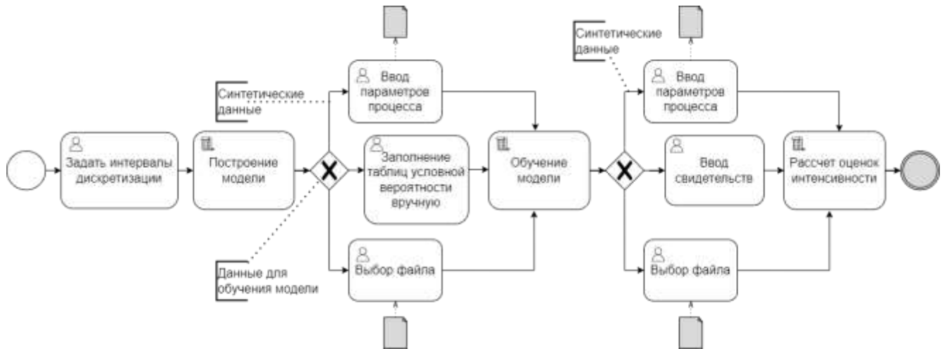
Рисунок 3.13 — Схема алгоритма обработки неопределенности задания конца исследуемого периода при оценивании интенсивности пуассоновского процесса по ограниченному объему доступных наблюдений
