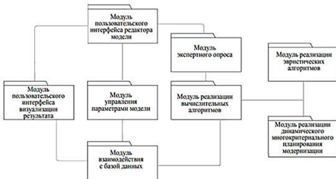
Рисунок 20. Диаграмма взаимосвязей пакетов разработанного прототипа программного модуля решения задач комплексного планирования функционирования и модернизации КИС.
