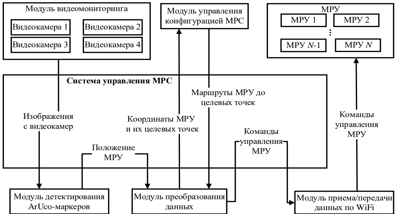
Рисунок 2.10 – Архитектура комплекса программно-аппаратных средств управления МРС
