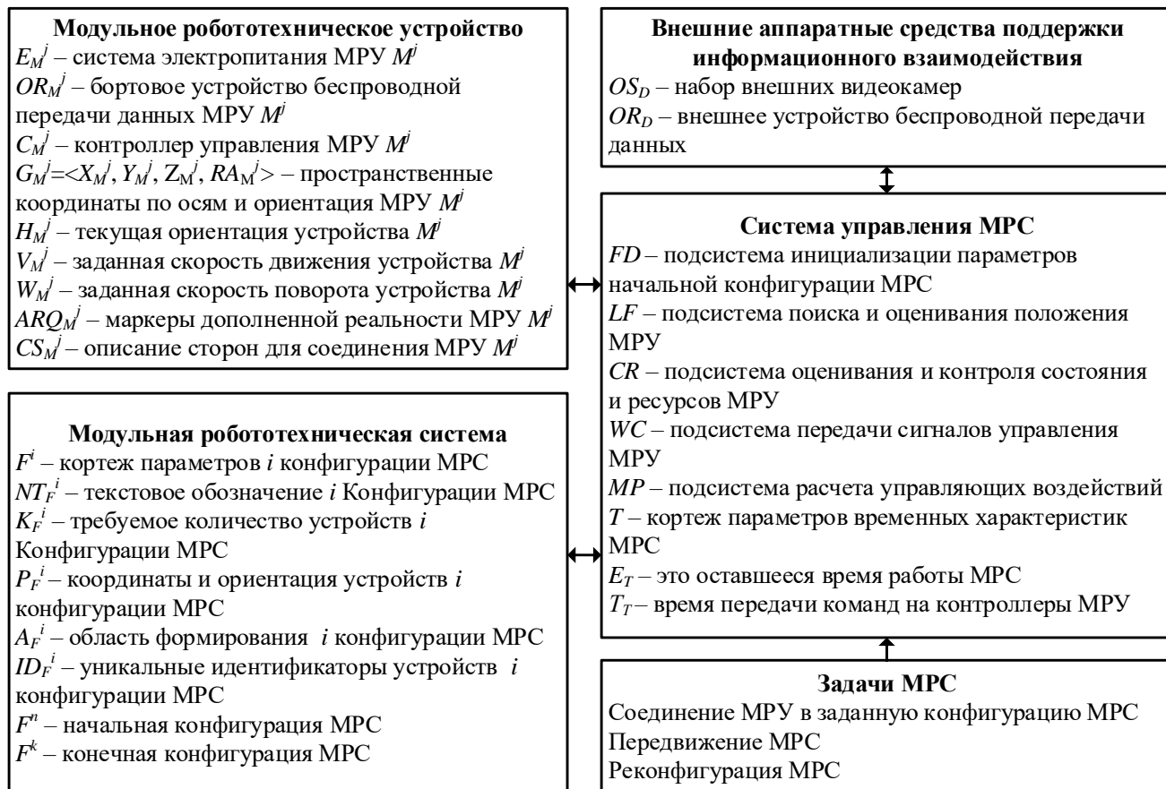
Рисунок 2.1 – Концептуальная модель управления модульной робототехнической системы
