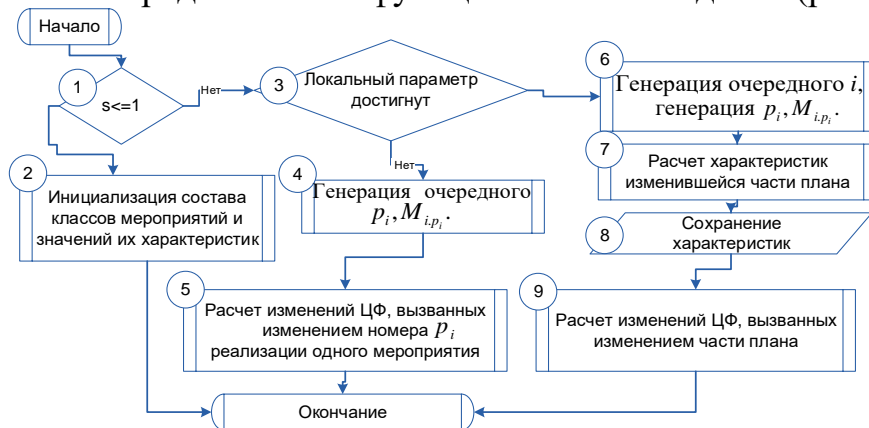
Рисунок 8 — Метод фрагментарно контролируемого случайного поиска
