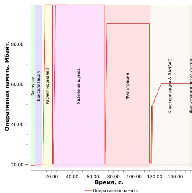
Рисунок 4.29 - Потребление оперативной памяти при обработке облака точек с использованием вторичной системы хранения
