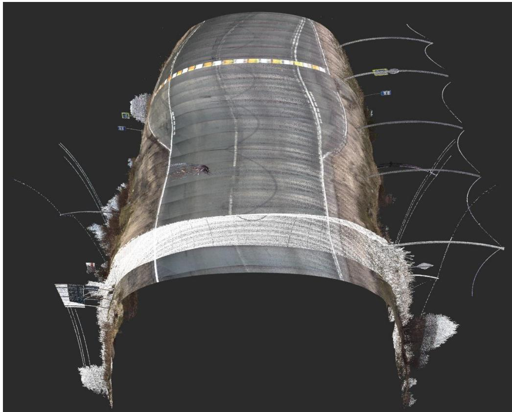
Рисунок 4.22 – Внешний вид октодерева, содержащего спроектированные точки
