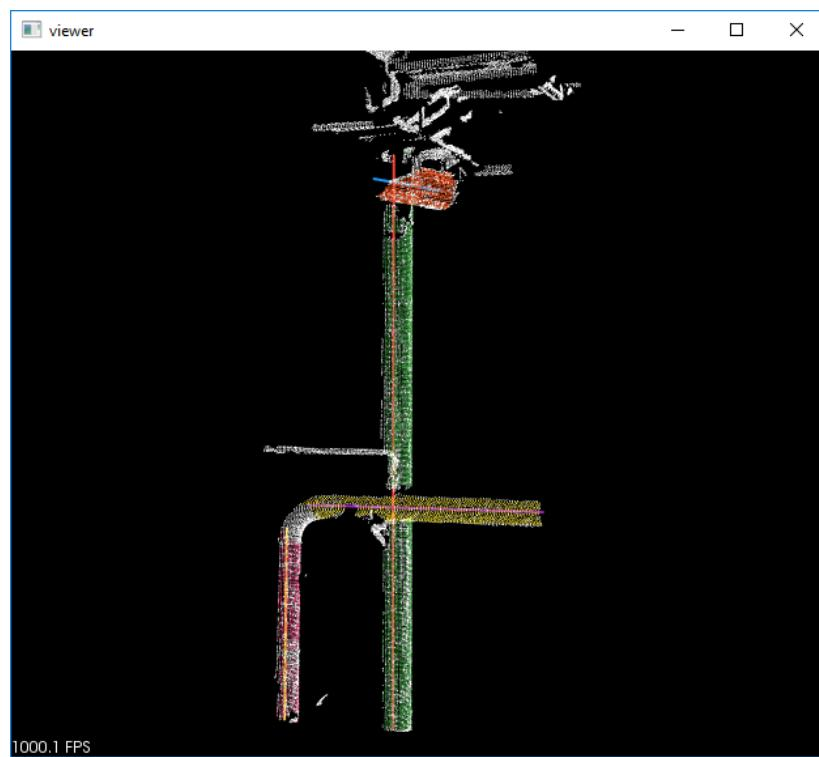
Рисунок 3.10 - Результат работы алгоритма поиска цилиндрических поверхностей
