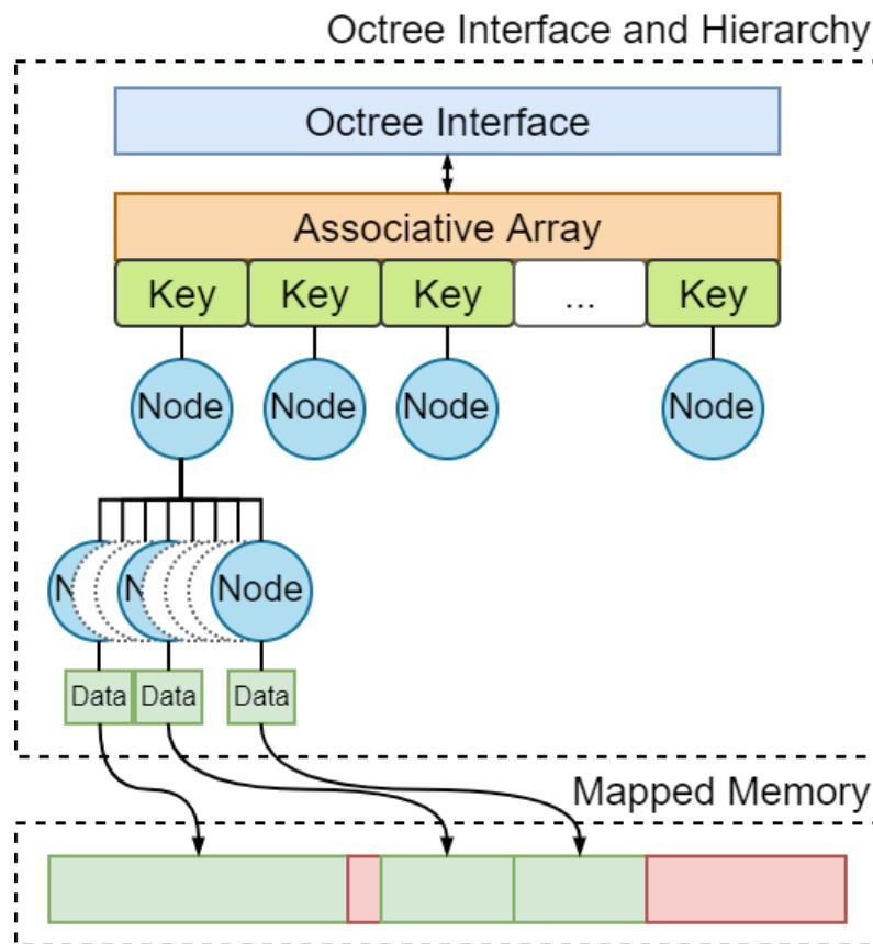
Рисунок 3.6 – Общая схема программной реализации октодерева на базе механизма отображения памяти
