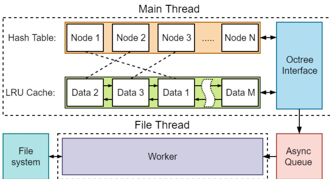
Рисунок 3.1 – Общая схема программной реализации октодерева на базе системы кеширования
