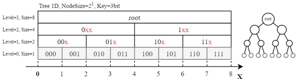
Рисунок 2.12 – Пример одномерного дерева, кодируемого при помощи одного бита на узел
