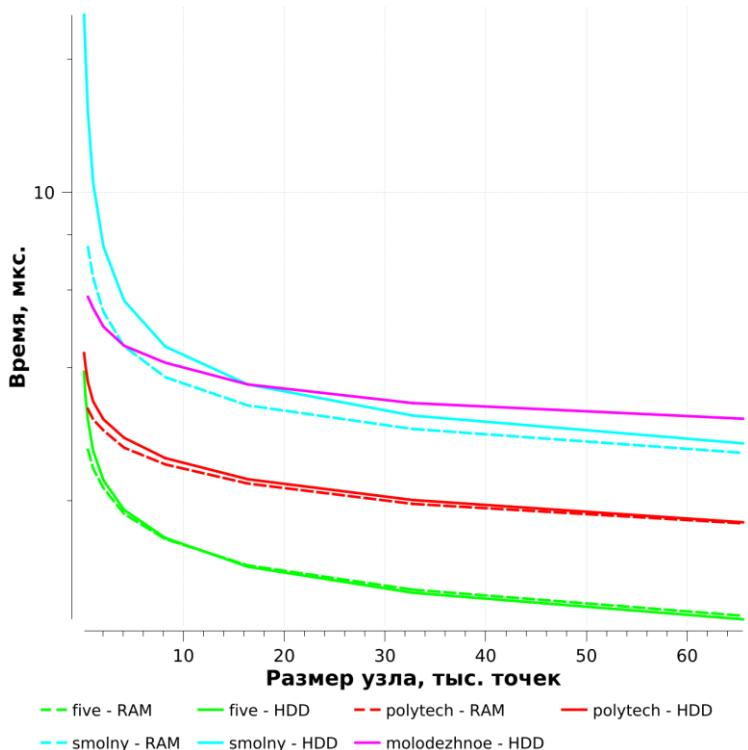
Рисунок 4.16 – Скорость поиска узлов октодерева в зависимости от размеров узла
