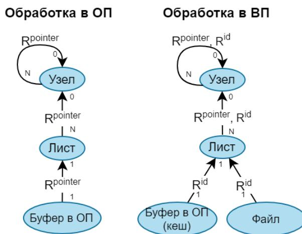
Рисунок 1.14 - Типовая структурная организация данных в октодереве
