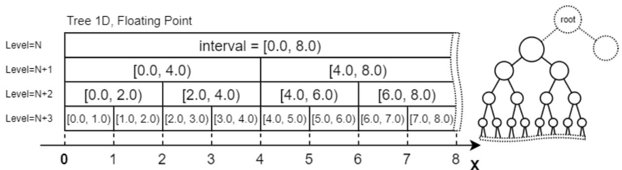
Рисунок 2.9 - Фрагмент октодерева на арифметике с плавающей точкой
