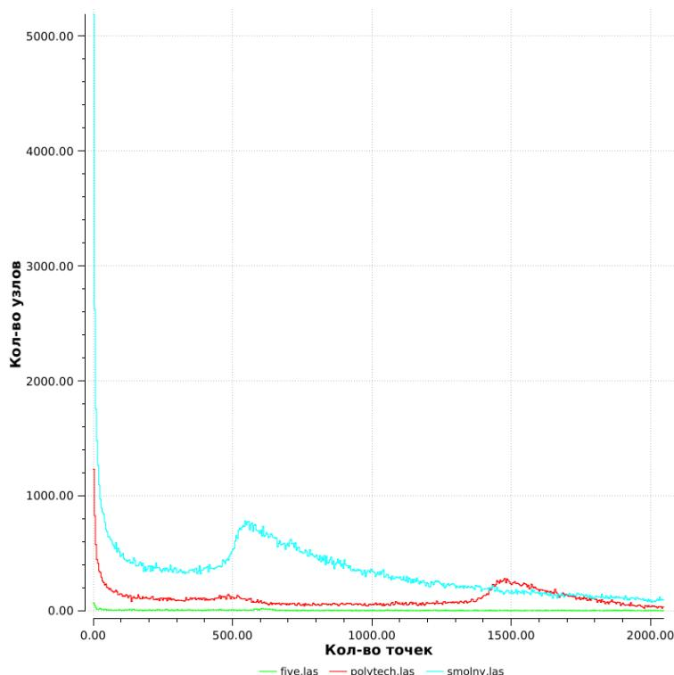
Рисунок 4.27 – Распределение точек в узлах октодерева
