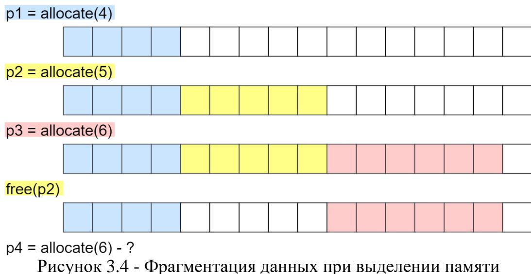
Рисунок 3.4 - Фрагментация данных при выделении памяти
