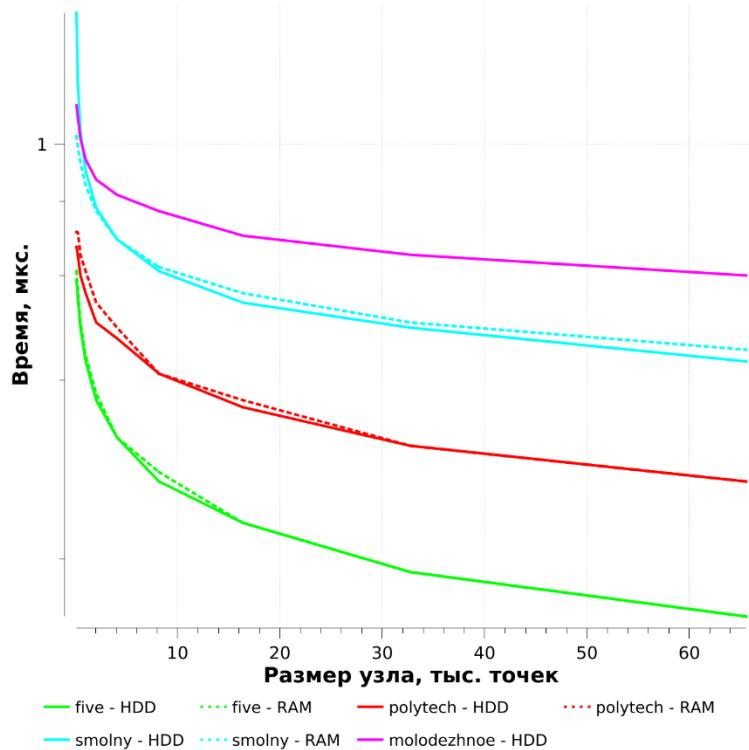
Рисунок 4.21 – Скорость поиска узлов октодерева в зависимости от размера узла
