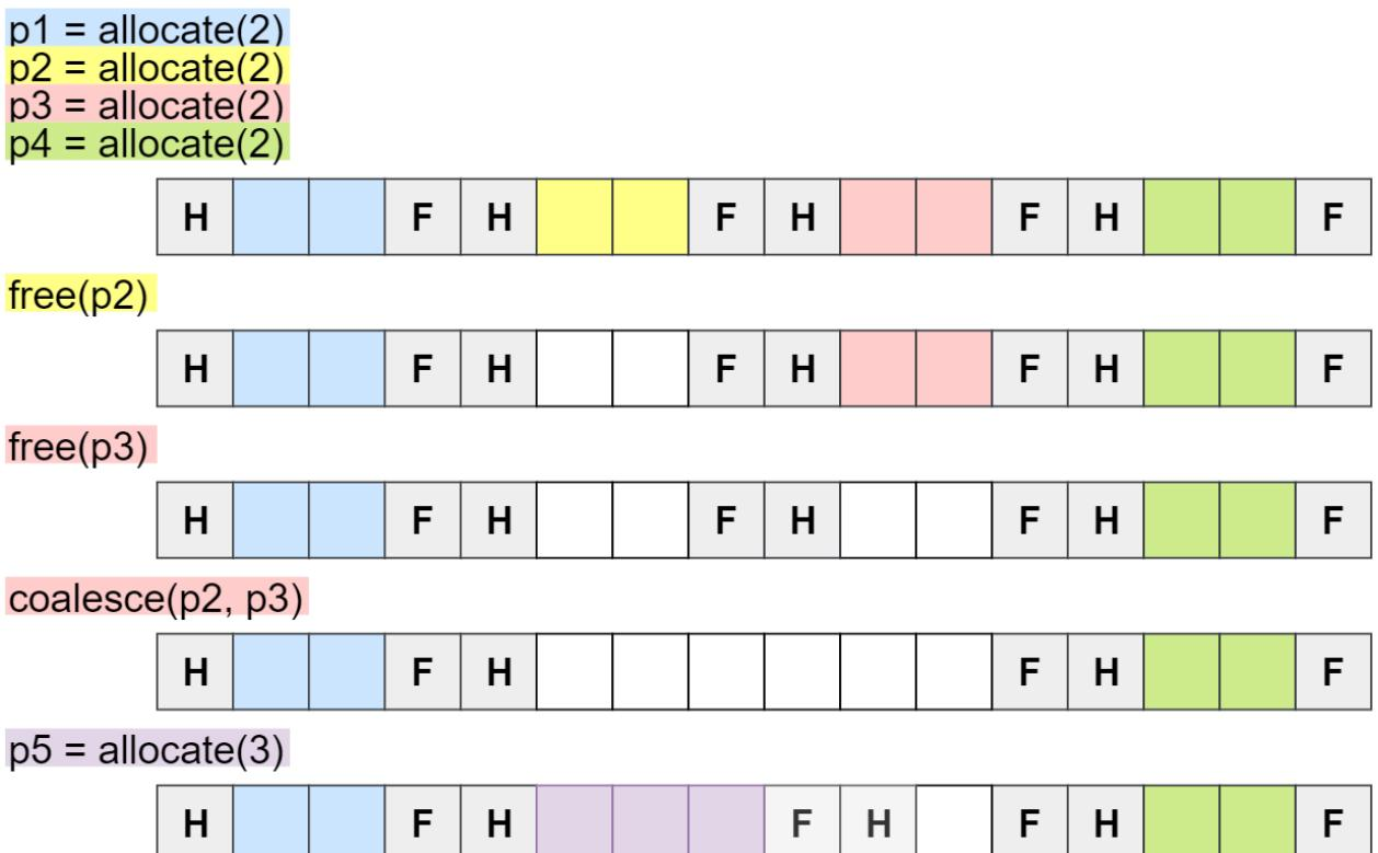
Рисунок 3.5 - Объединение блоков при освобождении памяти
