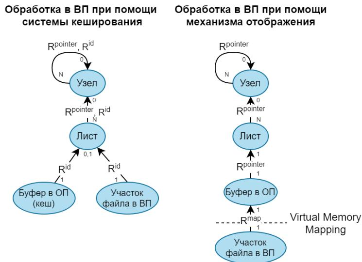
Рисунок 1.19 - Предложенные модификации структурной организации данных в октодереве
