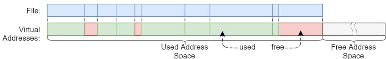
Рисунок 3.2 – Динамическая аллокация на отображаемой памяти
