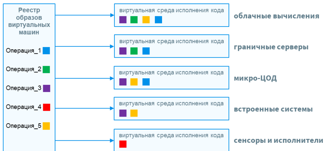
Рисунок 42. Реализация синтезированной технологии на базе контейнерной виртуализации
