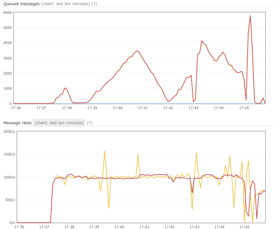
Рисунок П.27 – Зависимость длины очереди от времени работы двух ОММ Handler при нагрузке 1000 сообщений/с зависимость длины очереди сообщений от времени работы компонента (верхний график); зависимости числа полученных (нижний график, цвет желтый) и обработанных сообщений (нижний график, цвет красный) от времени работы компонента
