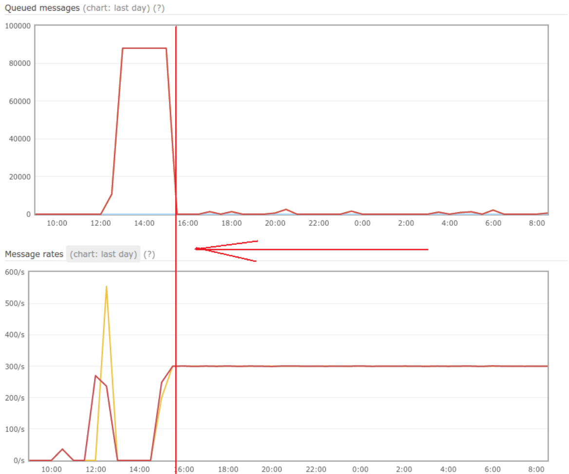
Рисунок П.24 – Состояние компонента обработки данных (OMM Handler) при загрузке 300 сообщений/ с на интервале времени с 15:40 до 9:20:
