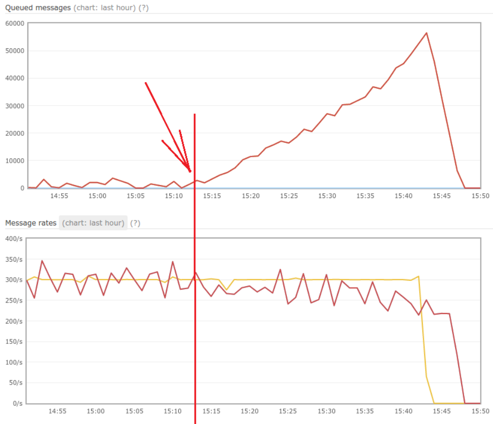
Рисунок П.23 – Состояние компонента обработки данных (ОММ Handler) при загрузке 300 сообщений/с на интервале времени с 14:50 до 15:50: зависимость длины очереди сообщений от времени работы компонента (верхний график); зависимости числа полученных (нижний график, цвет желтый) и обработанных сообщений (нижний график, цвет красный) от времени работы компонента
