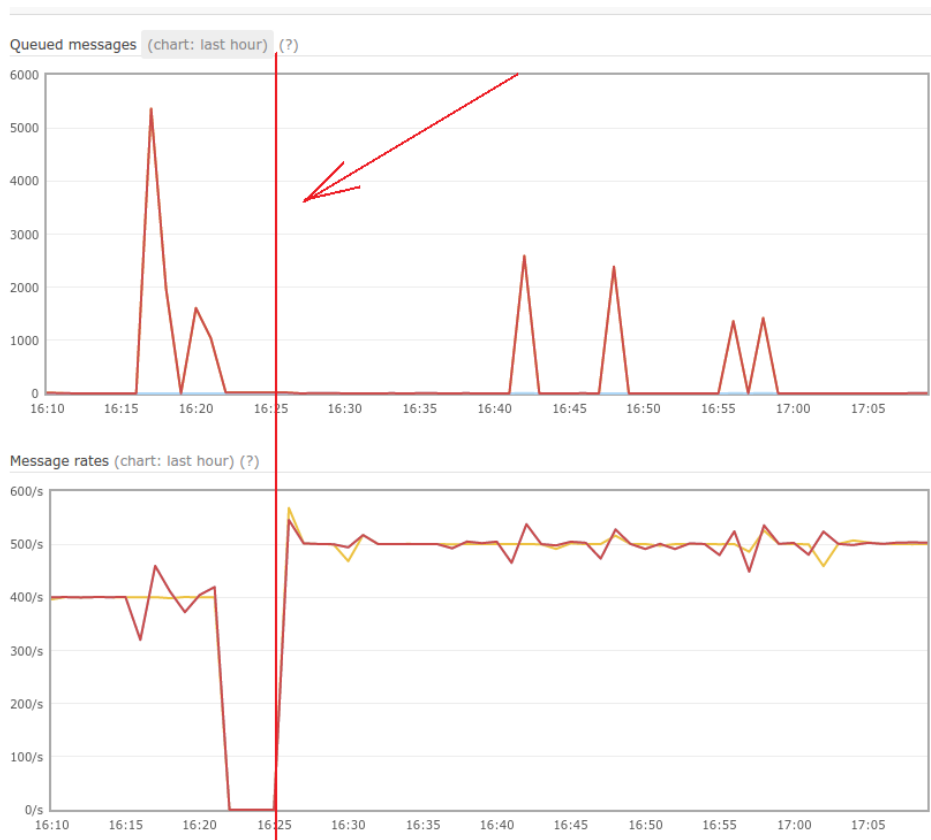
Рисунок П.25 – Зависимости длины очереди от времени работы двух ОММ Handler при нагрузке 500 сообщений/с:
