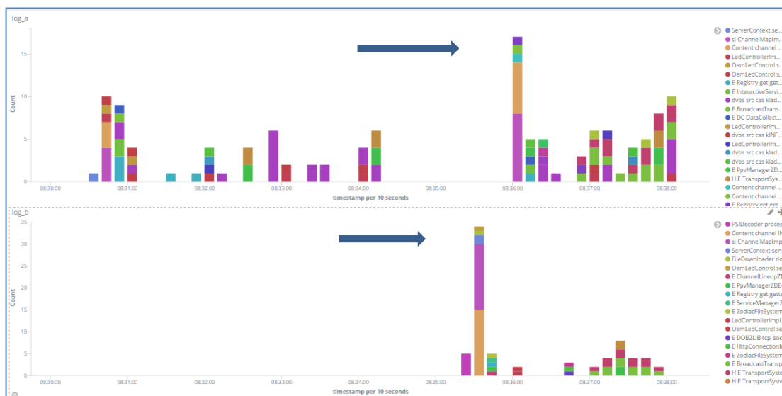
Рисунок П.11 – Записи в лог файлах ТВР, при наличии (верхняя диаграмма) и отсутствии ошибки "черный экран" (нижняя диаграмма)
