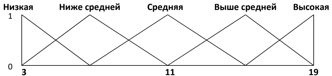
Рисунок 5.5 – Скорость вибрации (мм/с) как как интегральное состояние насосного агрегата заправочного оборудования стартового комплекса
