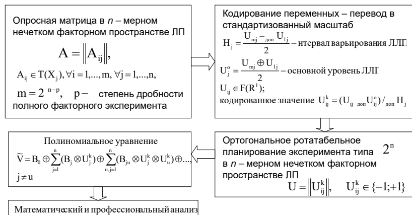
Рисунок 4.5 – Схема методики экспертного оценивания состояния СЛО в нечетком пространстве
