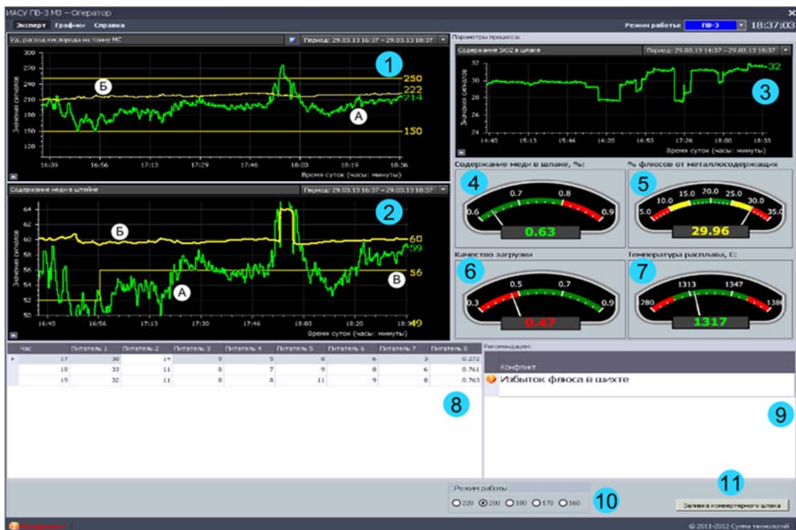
Рисунок 6.12 – Интерфейс на АРМ оператора (обозначения полей – в тексте):
