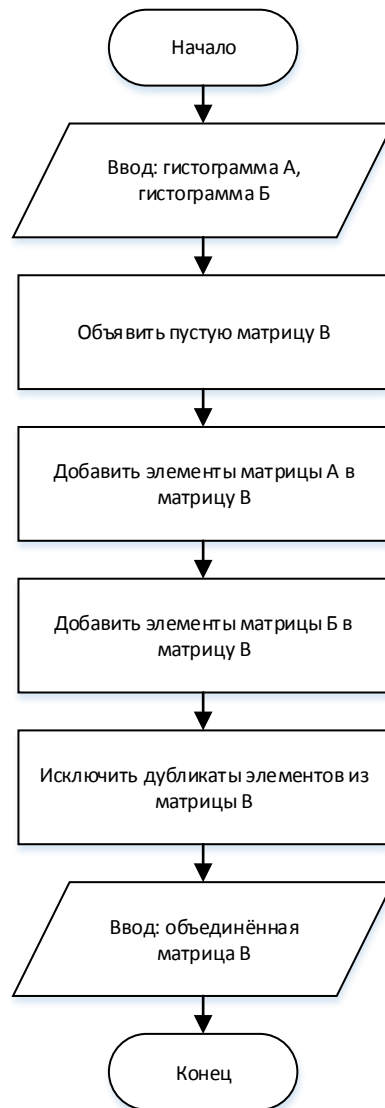
Рисунок 32 – Алгоритм слияния матриц кортежей
