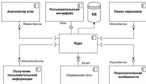
Рисунок 2 — Система компонент комплекса программ
