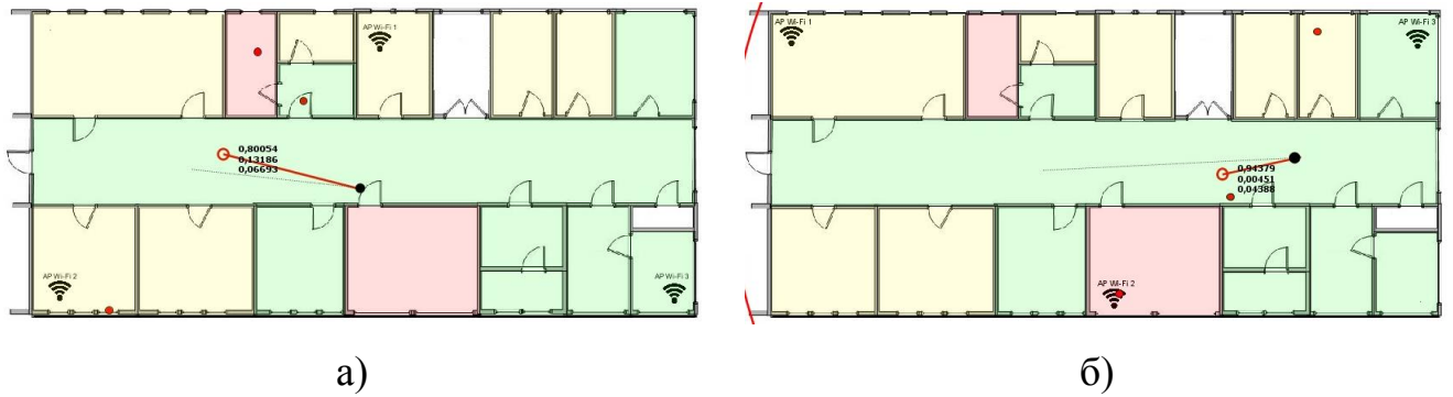
Рисунок 4.1 – Схема оптимального расположения трех точек доступа на исследуемой схеме этажа с точки зрения минимальной ошибки определения местоположения: а) карта № 3, б) карта № 6
