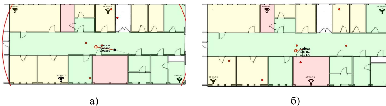
Рисунок 4.2 – Схема оптимального расположения четырех точек доступа на исследуемой схеме этажа с точки зрения минимальной ошибки определения местоположения: а) карта № 5, б) карта № 7
