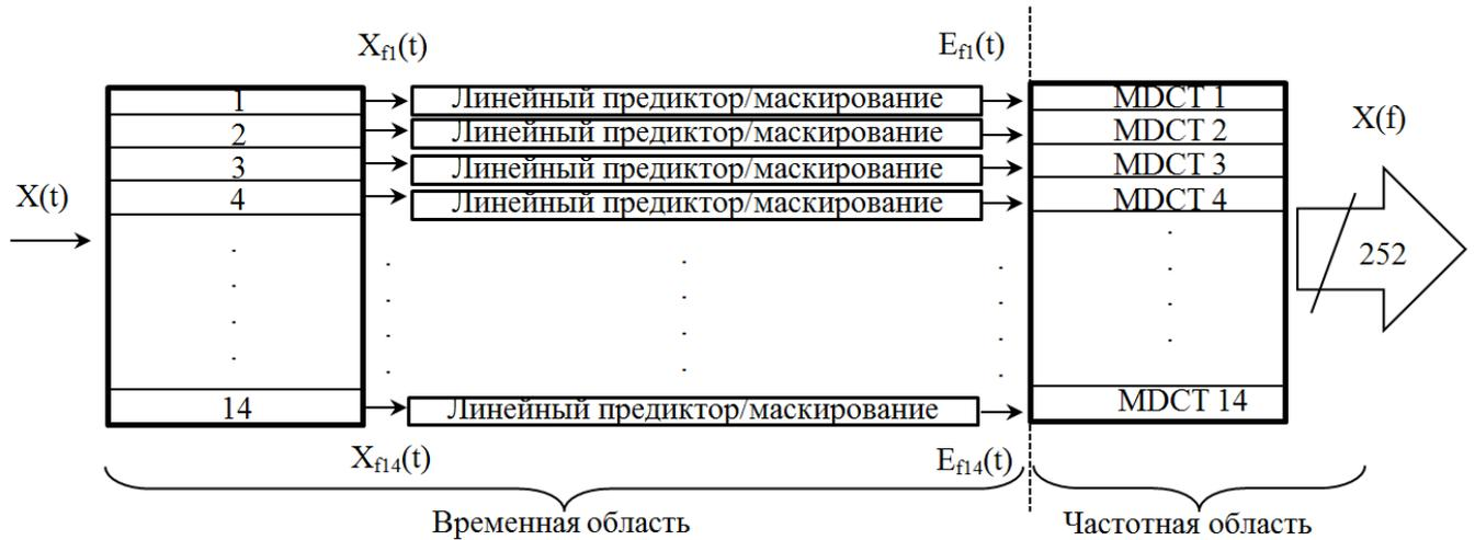
Рисунок 3.19 – Линейный предиктор в структуре ортогонального кодера
