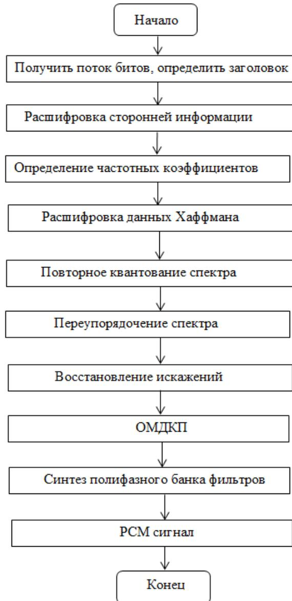
Рисунок 4.8 — Блочная диаграмма ортогонального декодера
