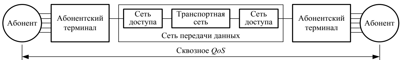
Рисунок 1.17 – Схематическое представление вкладов элементов ИКС в сквозное («из конца в конец») QoS
