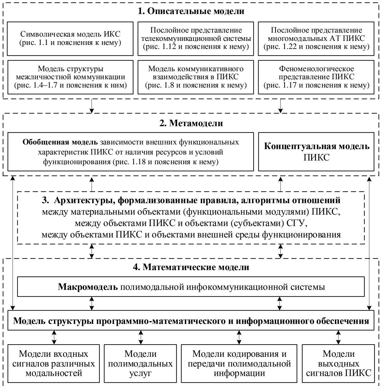
Рисунок 2.8 – Структура и состав системы моделей ПИКС
