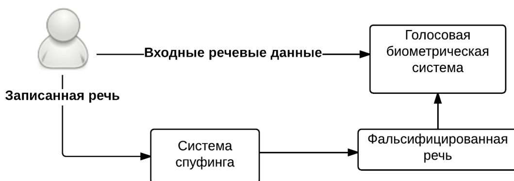
Рисунок 2.2 - Общая схема имитируемой атаки на модуль ввода биометрической информации текстонезависимой системы верификации
