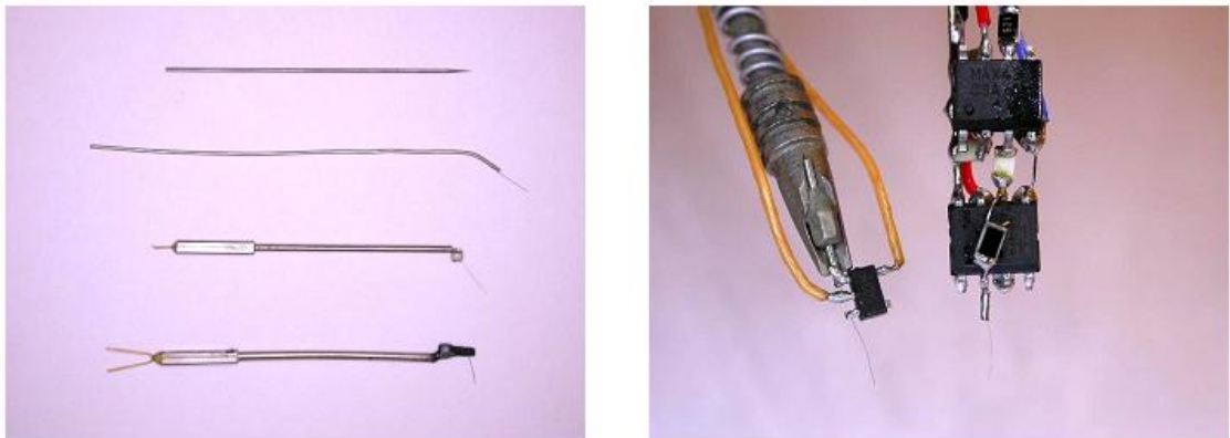
Рисунок А.5 – Щупы для подключения к чипу [106]
