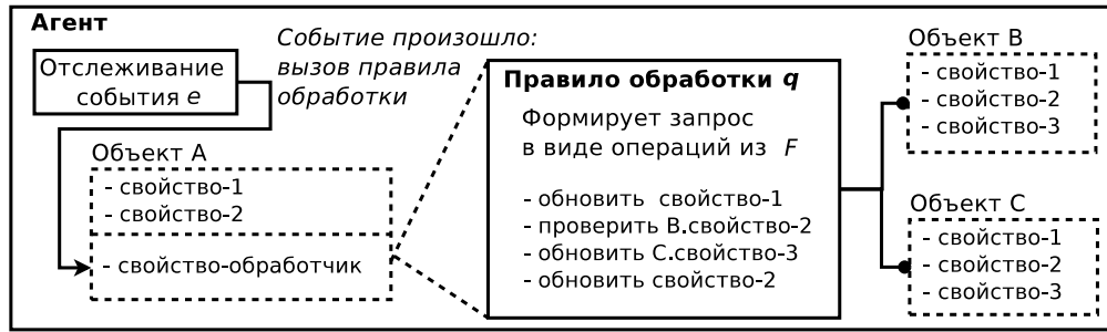
Рис. 3.5. Схема работы для обработки группы объектов при помощи свойства-обработчика.
